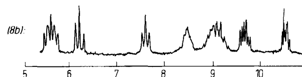
Abb. 1. ^1\text{H} -NMR-Spektren der Verbindungen (6), (7) und (8); jeweils 10-proz. \text{C}_6\text{H}_6 -Lösung; 100 MHz; 25°C; int. TMS = 10 \tau .
